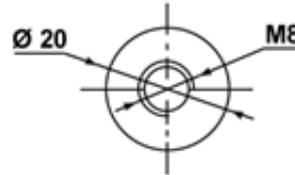
Anschluss: M8 Schraube oder M8 Poladapter
